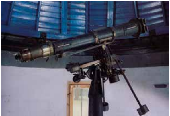
Cet héliomètre de 76 mm d'Utzschneider & Fraunhofer fut utilisé pour l'observation des transits de Vénus par des équipes de Gotha et de Strasbourg, respectivement aux Îles Kerguelen en 1874 et en Argentine en 1882.
